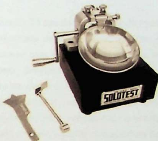
Figura 9 – Aparelho de Casagrande (direita), cinzel para solos argilosos (centro) e cinzel para solos arenosos (esquerda) (SOLOTEST 2010).
